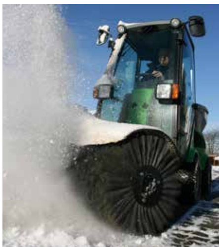
City Ranger 2250 sørger for feiing og støvsuging om våren og høsten, gressklipping om sommeren samt feiing av snø, strøing eller salting om vinteren.
