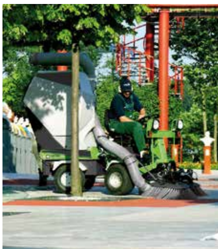
Med Park Ranger 2150 er skifte mellom utstyr gjort på mindre enn fire minutter - uten bruk av verktøy.
